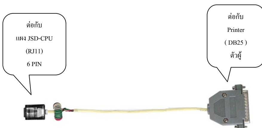
รูปที่ 3 ตัวอย่างสายสัญญาณ จากตู้สาขาไปยังเครื่องพิมพ์ Printer ( DB25 )
